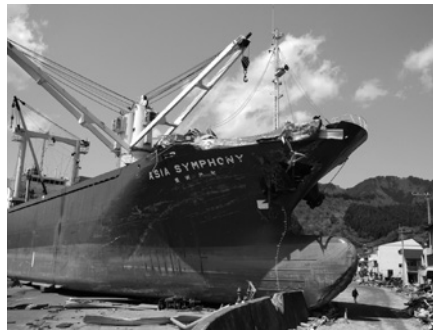
釜石港ではタンカーが岸壁に乗り上げ、一度、コンクリートの防波堤を破り、さらに岸壁に打ちたたかれ、食い込んでいる。
