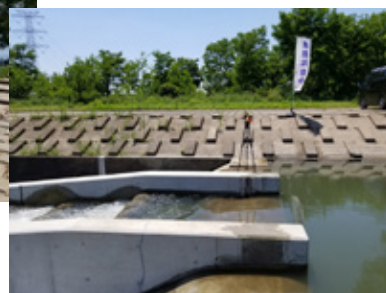
5月25日、新設された魚道出口にビデオカメラを設置して遡上調査を実施
